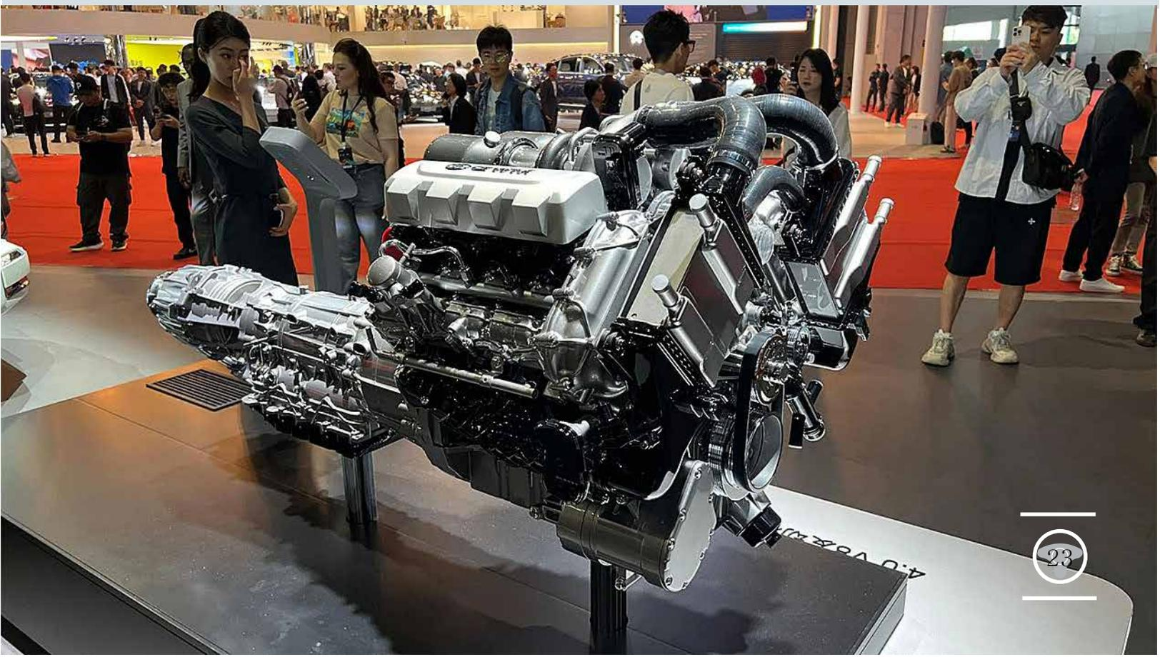
elado todas las cifras técnicas, se ha confirmado que utiliza una arquitectura "hot-vee", una disposición en la que los turbocompresores están montados en el interior de la "V" que forman las bancadas de cilindros. Esta configuración permite una respuesta más rápida del turbo, una mayor eficiencia térmica y una reducción notable en el retardo de entrega de potencia, lo que lo coloca a la altura de los propulsores más sofisticados a nivel internacional.
